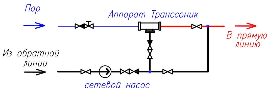
3. Монтаж параллельно сетевому насосу.
