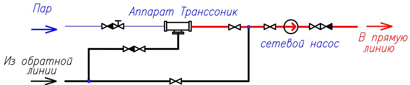
2. Монтаж на напоре сетевого насоса.
